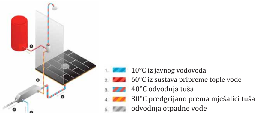
Slika 10. Izmjenjivač topline na odvodnoj cijevi tuša
