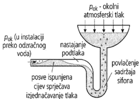
Slika 6. Primjer isisavanja sifona zbog pojave potlaka
