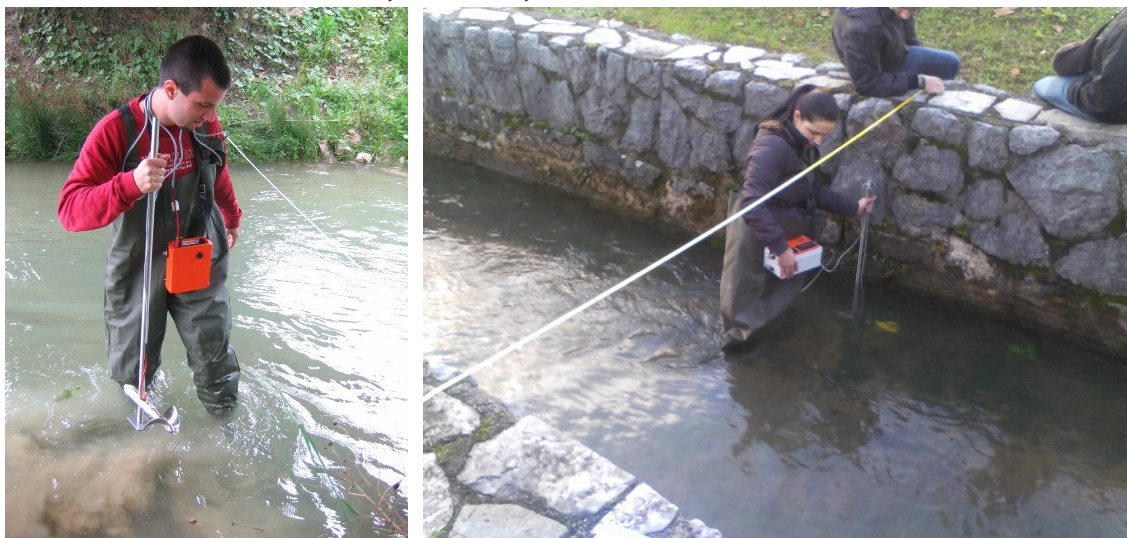
Slika 69. Mjerenja protoke hidrometrijskim krilom na Rakovom potoku u slivu Pazinčice (2005.) i na potoku Mlaka u Rijeci (prosinac 2012.)
