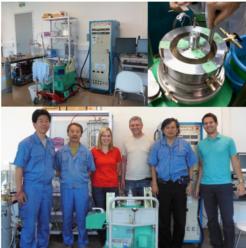
Slika 27. Instaliranje PORTABLE RING SHEAR APPARATUS - ICL 1 u Geotehničkom laboratoriju
