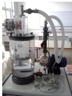
Slika 2. Fizikalni model HM 289 Peltonove turbine [5]
