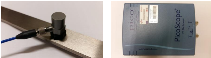
Slika 6. Piezoelektrični akcelerometar i pikoskop
