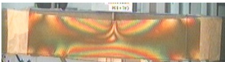
Slika 17. Zamjenska greda podvrgnuta opterećenju, treći korak opterećenja.
