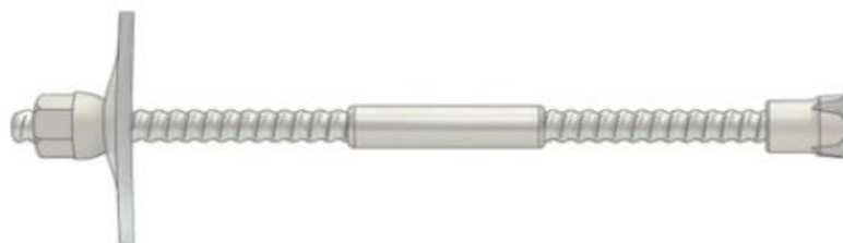
Slika 79. Shema Samobušivog sidra u pogledu sa strane
