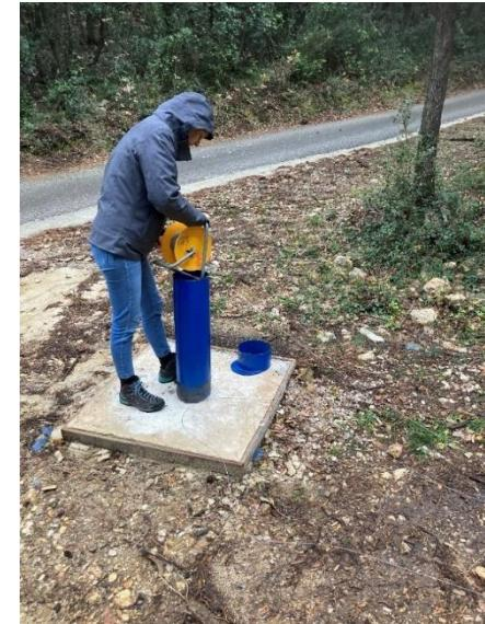
Uspostavljeni monitoring Hrv voda krajem 2021. - duboke bušotine za praćenje stanja u donjim dijelovima otočke vodne leće
