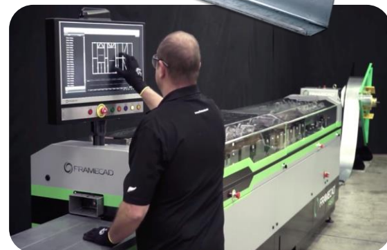
Izrada C-profila u stroju
